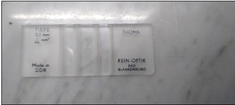
Figure.12: chambre de Thoma utilisée pour le comptage cellulaire .
